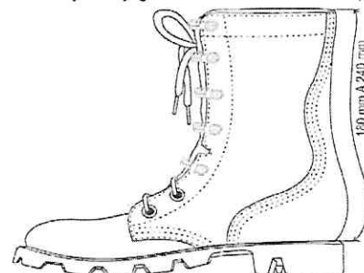
Figura 2. Vista ilustrativa de la bota con ojetes y ganchos de extracción rápida
