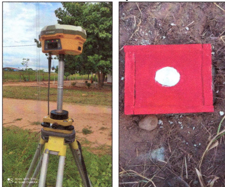
Ilustración 2: Monumentación Mojon Georreferenciado GPS-1
