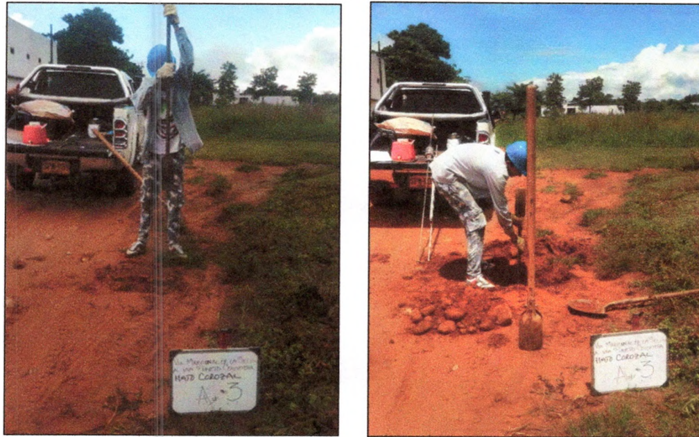
Ilustración 3: Apiques estudio geotécnico.
